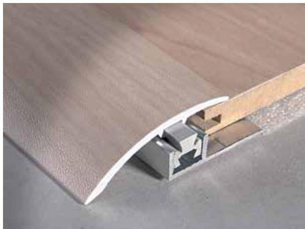
Perfil terminal para conectar desniveles entre 6 ÷ 11 mm patentado. Los elementos que componen el sistema MULTICLIP encajan perfectamente entre sí, gracias al clip de tecnopolímero y no "agarran". Este perfil permite conectar fácilmente dos pavimentos no coplanares. La conformación del encaje entre el clip y el perfil permite una rotación limitada del perfil de acabado que se ajusta perfectamente al desnivel a conectar.
